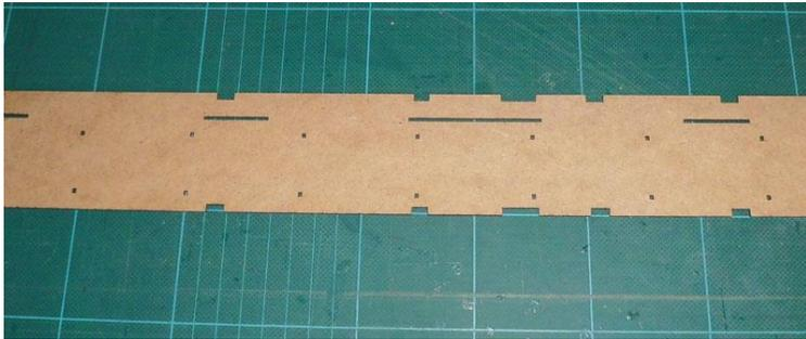
Die Bodenplatte werden mit Spritzspachtel besprüht und grundiert.
