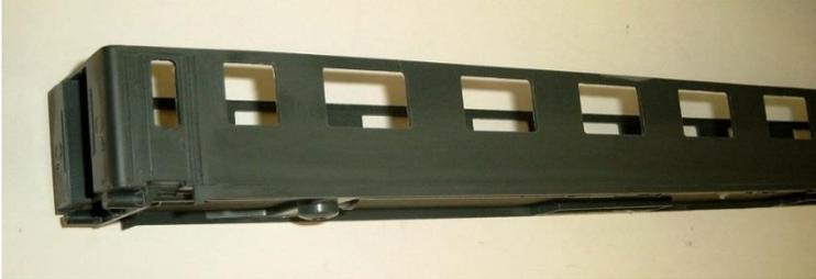
Nachdem wird das Gehäuseteil grundiert mit kunststoff primer, später lackiert in dem richtigen Endanstrich, beschriftet. und mit Klarschicht übersprüht. (Siehe weiter bei Farbanstrich)
