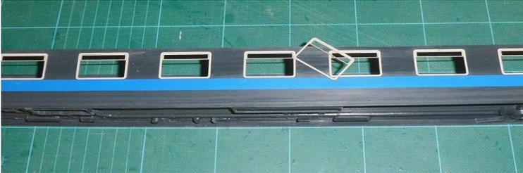
Nachdem die Fensterrahmen, (ausgelasert in Bristol), auf das Gehäuse geklebt sind und die Schürze vormontiert, wird alles grundiert.
