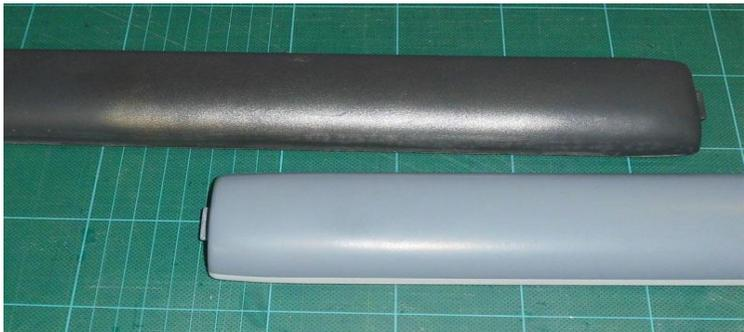
Die Wülste, neu in Resin gegossen werden grundiert und geschwartz.
